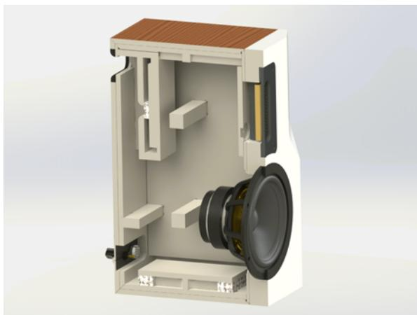
Im Innern der Kim arbeiten Helmholtzresonatoren möglichen Gehäuseresonanzen entgegen, deren Arbeitsbereich liegt um die 300-500 Hertz
