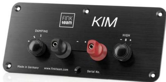
Die grundsätzliche Single-Wire-Klemme der FinkTeam stammt ebenfalls von Mundorf. Das Terminal bietet zwei Drehregler – der Hochtonpegel und die Dämpfung lassen sich anpassen
