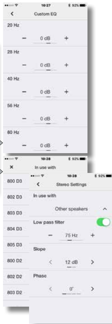
Στερεοφωνικές ρυθμίσεις: επιλογή ή διαμόρφωση φίλτρου χαμηλής διέλευσης.
