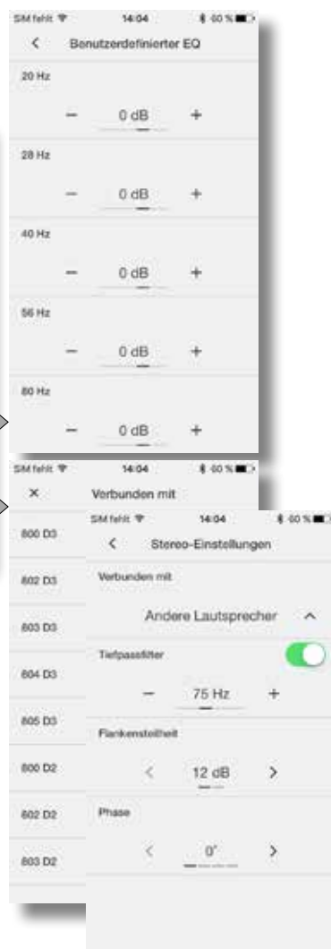
Stereo-Einstellungen: Einstellung des Tiefpassfilters bzw. Konfiguration.
