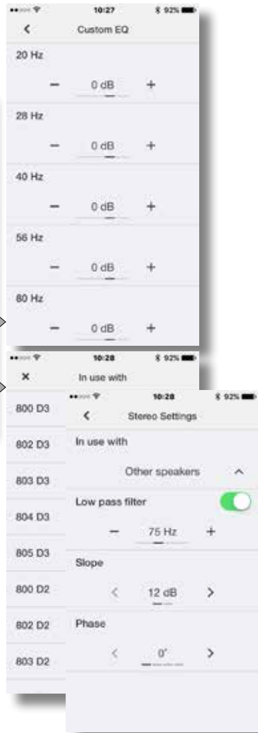
Stereo nastavení: volba dolnoproústného filtru či jeho konfigurace.
