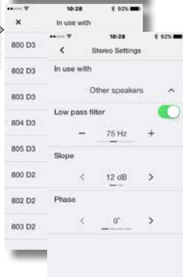
Ustawienia Stereo: wybór filtra dolnoprzepustowego lub jego konfiguracja.
