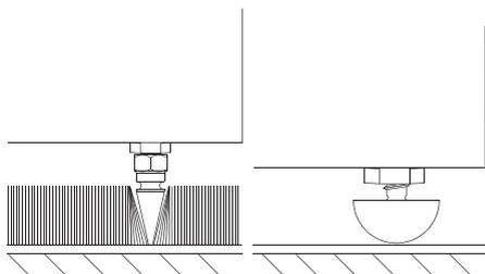
Ai diffusori 803 Diamond e 804 Diamond possono essere montati supporti regolabili a punta oppure dotati di un elemento in gomma, entrambi forniti tra gli accessori. Per le migliori prestazioni si consiglia di utilizzare le punte. Esse sono concepite per oltrepassare tappeti o moquette e trasferire il peso direttamente sulla superficie sottostante, sia per non lasciare segni evidenti sul tappeto o moquette, sia per non lasciare al diffusore un solido punto d'appoggio.
