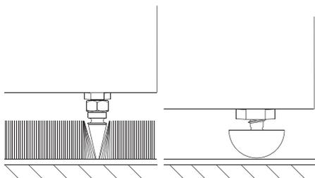
Tanto la 803 Diamond como la 804 Diamond puede utilizarse con puntas metálicas de desacoplo o pies de goma, siendo ambos suministrados con el paquete de accesorios que acompaña a dichas cajas. Las puntas de desacoplo están diseñadas para perforar alfombras y descansar sobre el suelo que hay debajo tanto para proteger dichas alfombras de daños importantes como para proporcionar un fundamento sólido a la caja acústica.
