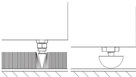
803と804 ダイヤモンドは、ゴム脚がスパイクのいずれかを装着できます。これらは、アクセサリ・バック に同封されています。スパイクは可能であれば常時ご使用いただくことをお勧めします。このスパイクは、カーペットを貫通し床に直接設置するように設計されていて、カーペットがくぼんでしまうことを防ぎながらスピーカーに強固な床面構造を与えます。
