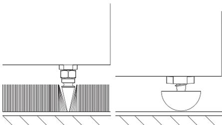
An die 803 Diamond und die 804 Diamond können sowohl Gummifüße als auch Spikes angebracht werden – beide liegen im Zubehörpaket. Wir empfehlen, wann immer möglich, Spikes zu benutzen. Die Spikes sind für Teppich gedacht, durch den sie sich hindurchbohren und auf der Bodenoberfläche aufliegen. Dadurch wird der Teppich nicht eingedrückt und der Lautsprecher stabil aufgestellt.
