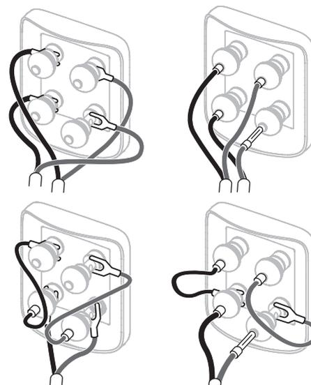
Sul retro di ciascun diffusore sono presenti due coppie di morsetti che consentono il collegamento in bi-wiring (figure in alto). Per le connessioni tramite un unico cavo, vengono forniti dei cavetti con terminazioni a banana da un lato e a forcella dall'altro per unire tra loro con un ponticello i morsetti della stessa polarità.
