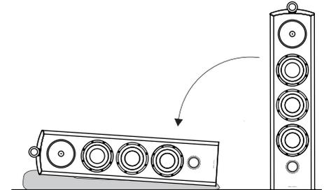
Befindet sich der Lautsprecher in der Nähe seiner endgültigen Position, können die Spikes bzw. GummifüÙe angebracht werden. Dies ist in den folgenden Abschnitten beschrieben.
