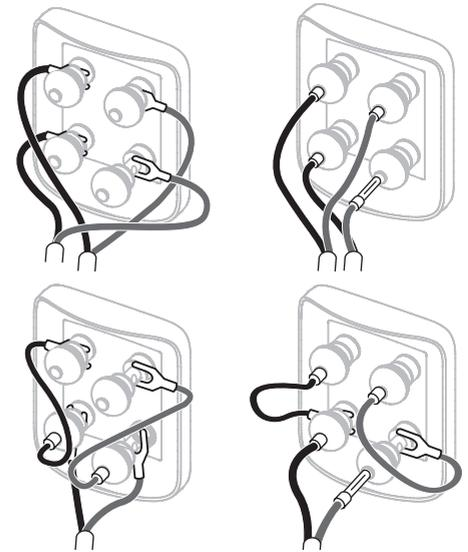
Il y a deux paires de prises à l'arrière de chaque enceinte, afin de permettre le bi-câblage (voir schéma ci-dessus). Pour une liaison conventionnelle avec un seul câble, utilisez les câbles fournis permettant de relier les prises de même polarité sur l'enceinte.
