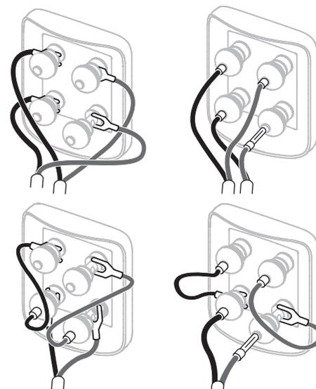
Er bevinden zich op de achterzijde van elke luidspreker twee paar aansluitingen om bi-wiring (bovenste) mogelijk te maken. Voor conventionele verbinding met een enkele kabel brengt u de bijgevoegde doorverbindingen aan tussen de aansluitingen van dezelfde polariteit.
