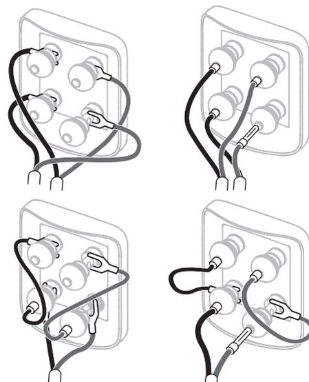
На задней панели колонок имеются по две пары клемм, чтобы обеспечить возможность подключения би-ваерингом (двухкабельное, bi-wiring, см. выше). Для обычного, однокабельного подключения, подсоедините проводники к клеммам соответствующей полярности.
