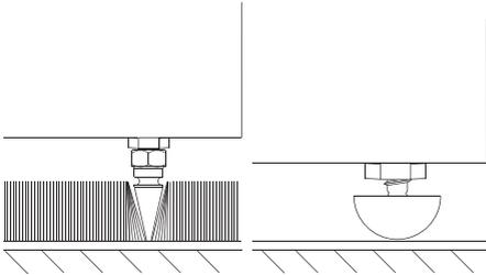
Les 803 Diamond et 804 Diamond peuvent être équipées au choix de pieds proposant une pointe ou un patin de caoutchouc à leur extrémité. Nous recommandons d'utiliser les pointes, qui sont conçues pour traverser la moquette et prendre directement appui sur la surface solide du sol.
