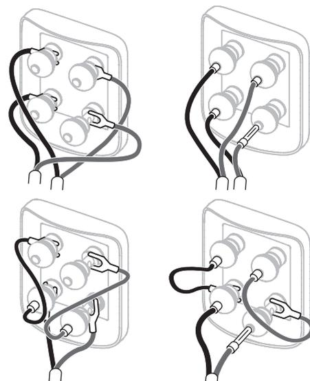
每台扬声器的背部均有两对插座，可用于双线连接(上)。对于传统的单线连接，使用随附的接线与同极性的插座相连。
