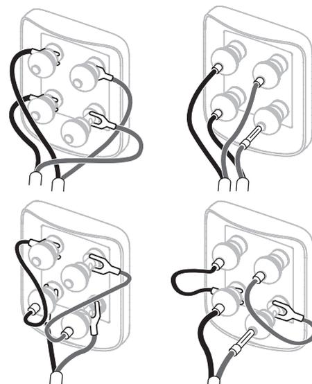
An der Lautsprecherrückseite befinden sich jeweils zwei Paar Anschlussklemmen, wodurch Bi-Wiring möglich ist (siehe oben). Im konventionellen Betrieb bringen Sie die beiliegenden Kabelbrücken an, um die Anschlussklemmen gleicher Polarität miteinander zu verbinden.
