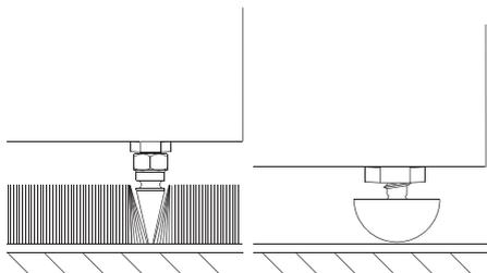
De 803 Diamond en 804 Diamond kunnen worden uitgerust met spikes of rubber voetjes – beide vindt u in de doos met toebehoren. Voor optimale prestaties raden we u aan de spikes te gebruiken. De spikes zijn ontworpen om door het tapijt heen te prikken en zo het tapijt te beschermen tegen afdrukken en de luidspreker stevig op de onderliggende vloer te plaatsen.
